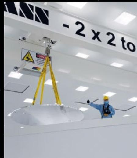
Abb. 3: Reinraumkran im Betrieb
